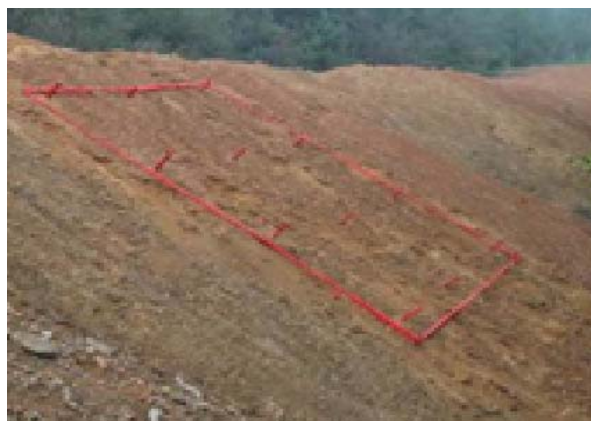
K20+900 处模拟料场监测小区
